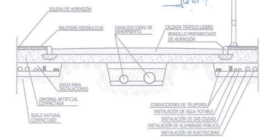
SECCION TIPO CALLE S/E
